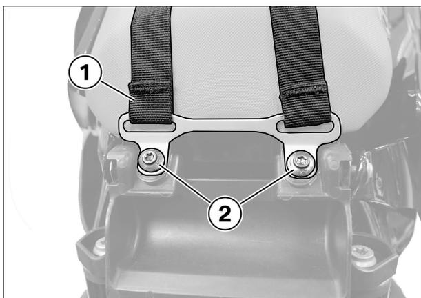
► Anbindung Tankrucksack hinten einbauen
