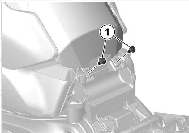
► Tank hinten lösen
