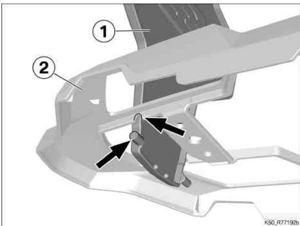
▷ **Deckel in Blende einsetzen und einbauen**
