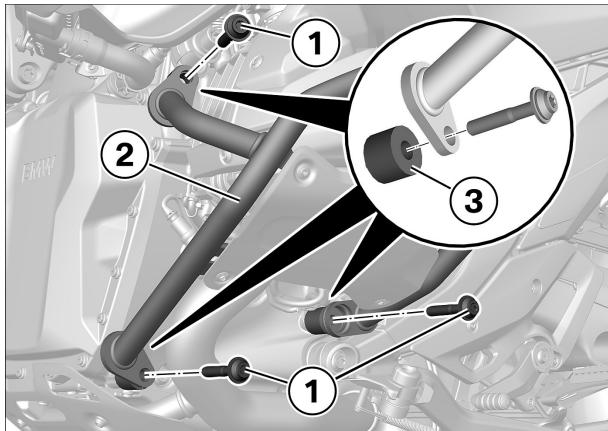
► **Motorschutzbügel links einbauen**
