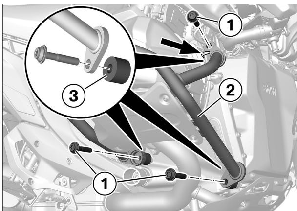
► **Motorschutzbügel rechts einbauen**
